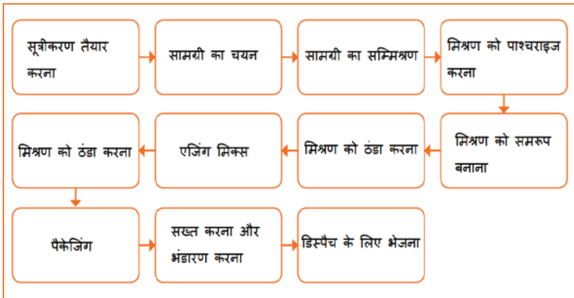
चित्र 4.4.1 आइसक्रीम निर्माण की प्रक्रिया का अवलोकन
